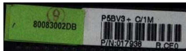
Die Board-Revision auf dem Aufkleber auf dem äußersten ISA-Stecker
