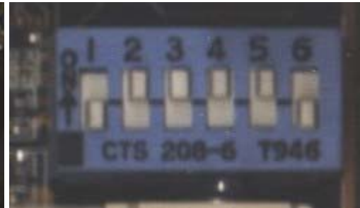
SW2 und SW1 eines K6XV3+/66 mit Einstellung 011-110-00010 (66x2.5, 2.8V)
