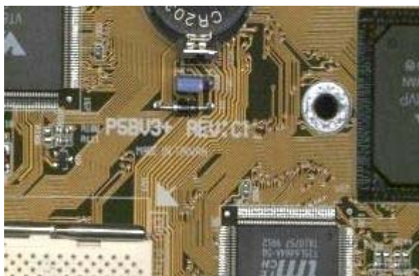
Die Revisionsnummer auf dem Board. Unten links der Prozessorsockel, oben die CMOS-Batterie.
