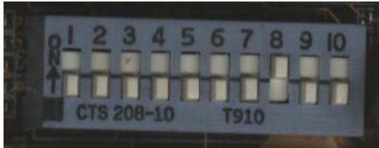
SW1 eines P5BV3+ mit Einstellung 000-000-0100 (100x3.5, 2.2V)
